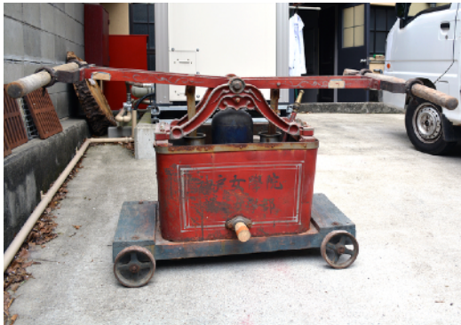
写真7 消防ポンプ (神戸女学院)
