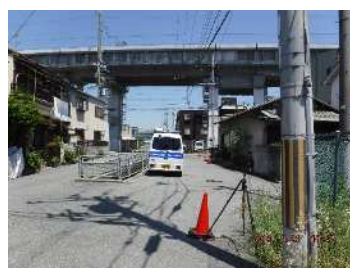
図 4-2 新幹線騒音の測定
