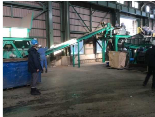
図表 32 破碎後ホッパーへ投入
