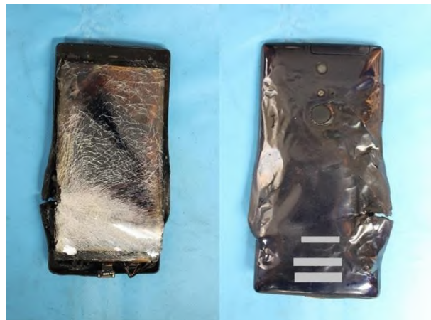
写真 2-2 スマートフォンの焼損状況
