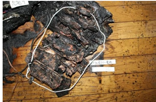
写真 1-2 焼損した電池
