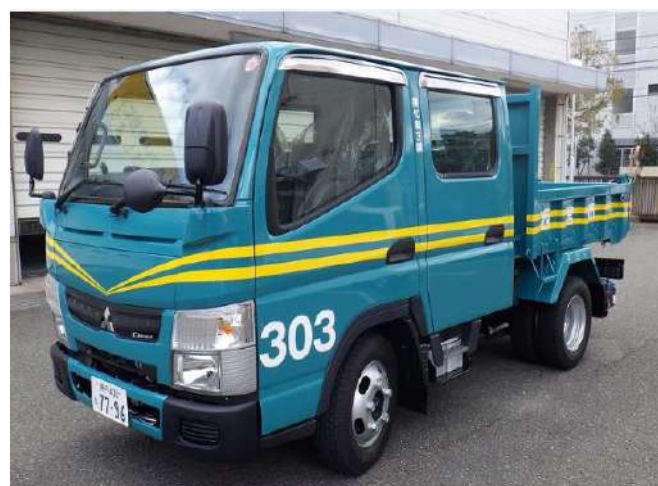
ダンプ (ダブルキャビン) 車 (人員器材搬送・土砂終末処理用)
