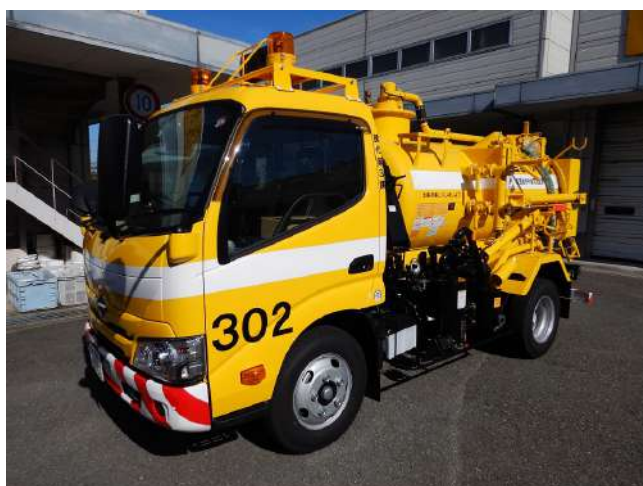
バキュームダンパー車 (汚泥吸引用)
