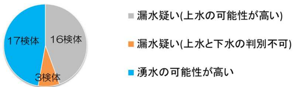
図3 水質試験による漏水の判別結果(36検体)
