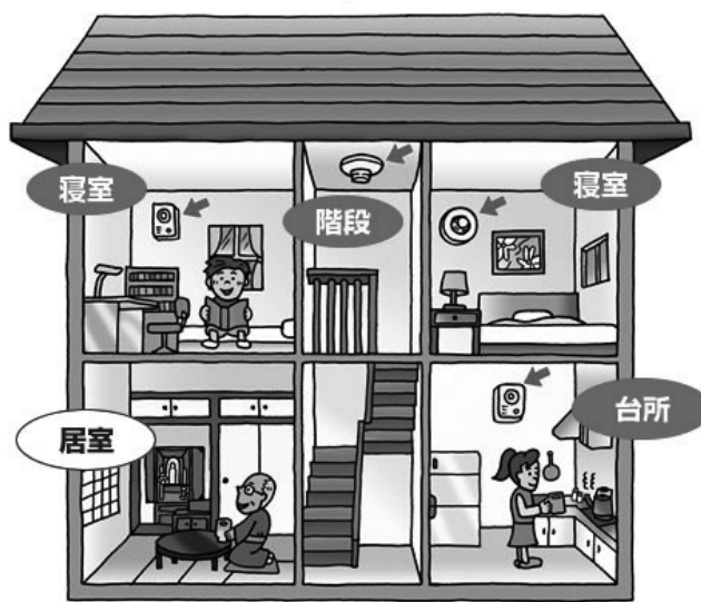
注意点…住宅用火災警報器が正常に働くためには、維持管理が必要です。ほこりがたまったり電池が切れたりしないよう日頃から点検と手入れをしておきましょう。
